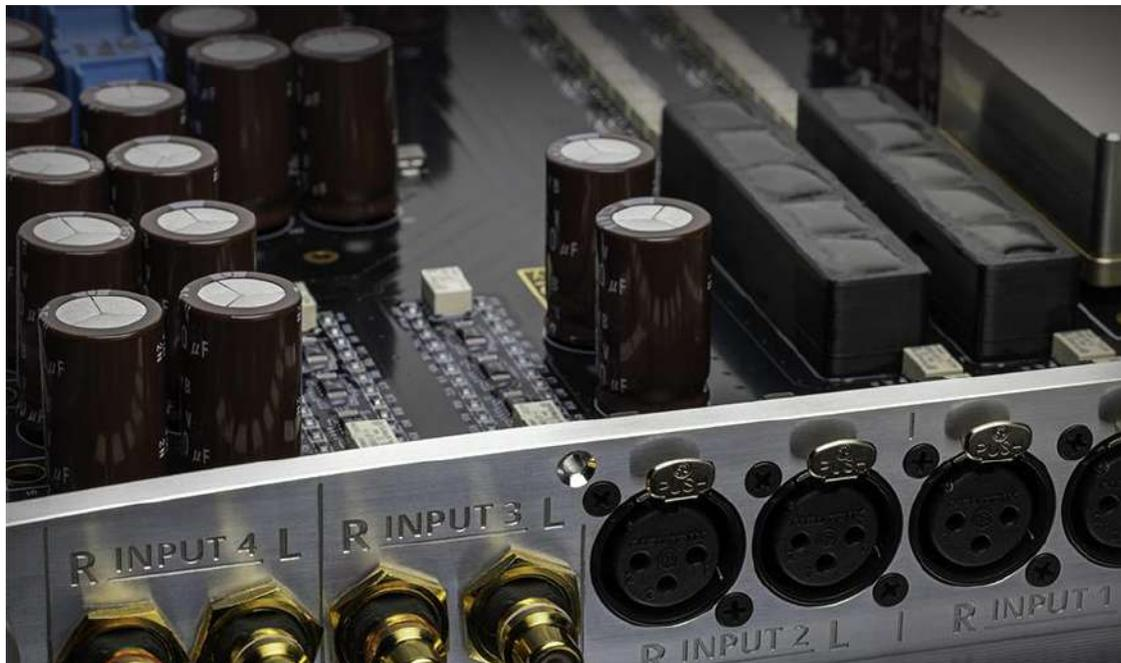
使用されていないアナログ入力は完全に切断され、回路の他の部分から分離されます。入力が選択されていないときは、ケーブルのグラウンドもフローティングされ、クロストークをシャットアウトします。各アナログ入力は、オプションで 0dB または +6dB のゲインを備えた超低ノイズ、低歪みのバッファで慎重にバッファリングされます。その後、ハイブリッド DAC で使用されるのと同じ 75 オームの定インピーダンス出力段に切り替えられます。アナログ コンバーター部には、CPU などのノイズ源となるデジタル処理回路がまったく無いため、専用のプリアンプのように、繊細な信号に干渉が加わることはありません。その結果、デジタル、そしてアナログのあらゆるソースから究極のアナログ信号純度が得られます。
