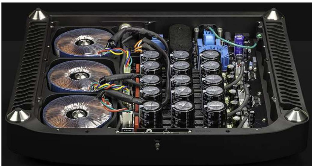
のシリコンカーバイド整流器によって DC に変換された生の電力は、新しい最適化されたインダクターとコンデンサーのバンクによってフィルタリングされ、生の DC から残留ノイズの大部分が除去されます。次に、MSB 伝統の超低ノイズリニア電源によって安定化が図られ、5 系統の独立した電源レールに送られます。
